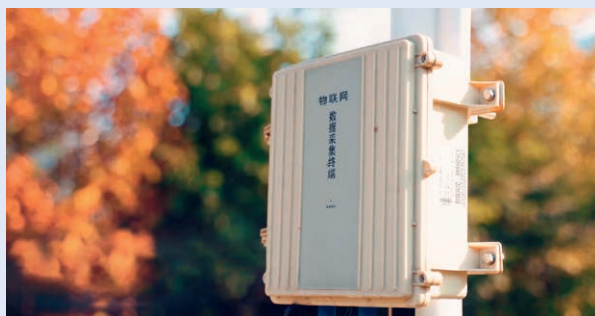
土壤溫濕度監測設備
