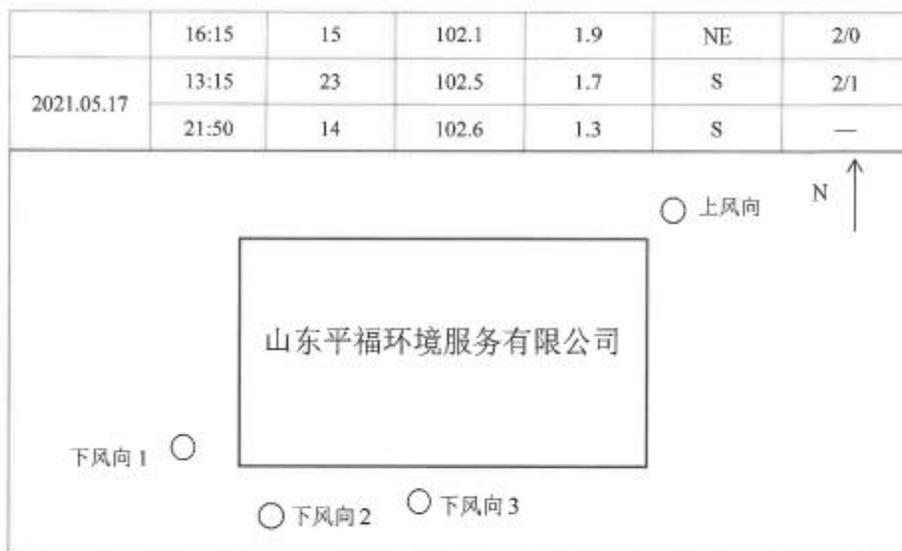
图1 无组织废气检测布点图
